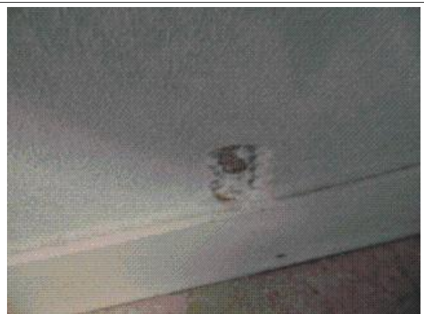
Prélèvement - P86 : CH CHOLET INTERNAT / R+2 / 13.2.01.16 - Enduit- (Absence d'amiante)
