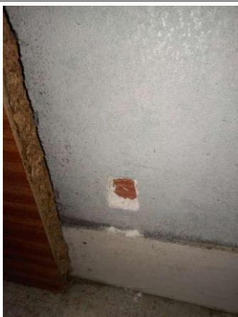
Prélèvement - P103 : CH CHOLET INTERNAT / R+3 / 13.3.01.10 - Enduit- (Absence d'amiante)
