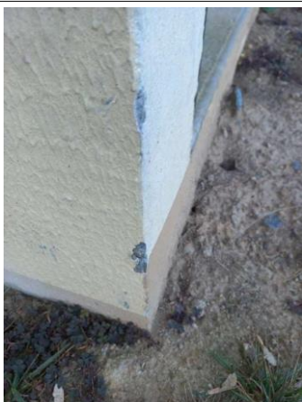
Prélèvement - P121 : CH CHOLET INTERNAT / RDC / Façade - Enduit- (Absence d'amiante)
