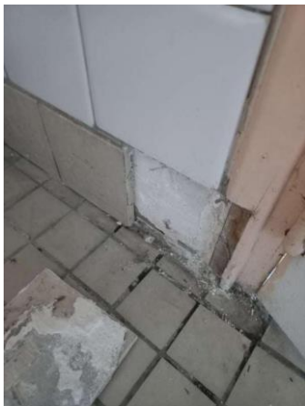
Prélèvement - P3 : CH CHOLET INTERNAT / RDC / 13.8.01.28 - Colle de plinthe- (Absence d'amiante)
