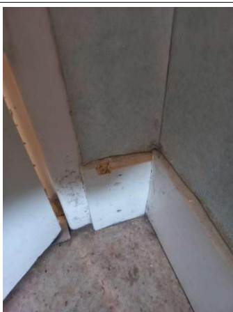
Prélèvement - P101 : CH CHOLET INTERNAT / R+3 / 13.3.01.10 - Peinture- (Absence d'amiante)
