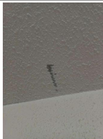
Prélèvement - P98 : CH CHOLET INTERNAT / R+3 / 13.3.01.11 - Enduit - BE- (Présence d'amiante)
