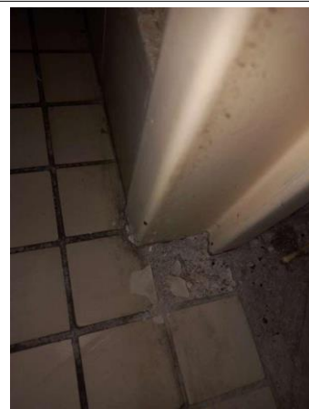
Prélèvement - P71 : CH CHOLET INTERNAT / R+2 / 13.2.01.06 - Colle de carrelage- (Absence d'amiante)
