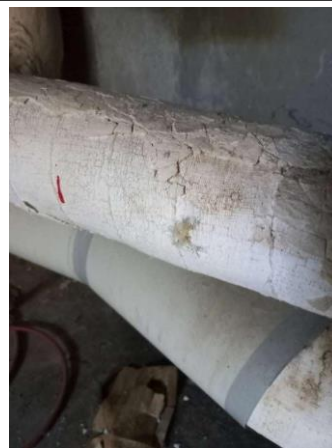
Prélèvement - P118 : CH CHOLET INTERNAT / R-1 / Station - Calorifugeage- (Absence d'amiante)
