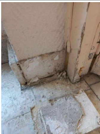
Prélèvement - P13 : CH CHOLET INTERNAT / RDC / 13.8.01.26 - Colle de carrelage- (Absence d'amiante)
