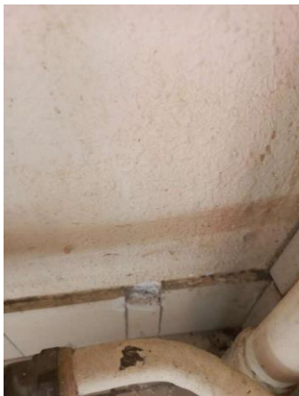
Prélèvement - P72 : CH CHOLET INTERNAT / R+2 / 13.2.01.06 - Colle de plinthe- (Absence d'amiante)
