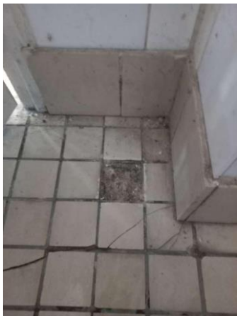
Prélèvement - P1 : CH CHOLET INTERNAT / RDC / 13.8.01.28 - Colle de carrelage- (Absence d'amiante)
