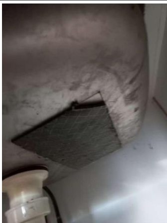
Prélèvement - P20 : CH CHOLET INTERNAT / RDC / 13.8.01.29 - Plaque bitumineuse - BE- (Présence d'amiante)
