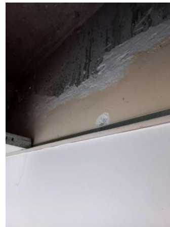
Prélèvement - P8 : CH CHOLET INTERNAT / RDC / 13.8.01.28 - Enduit- (Absence d'amiante)
